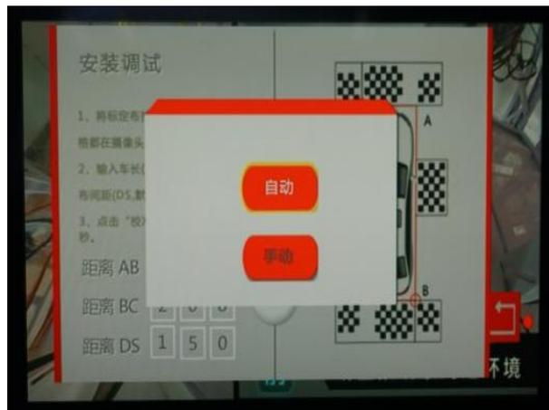
12. 校准参数输入完成后点击校准，选择“自动”，系统开始进入自动校准，若提示校准失败，请确认校准布的摆放和参数是否正确。如果光线环境不好，无法完成自动校准，请参照“360全景拼接说明”文档里的3D360校准说明，进行手动校准。
