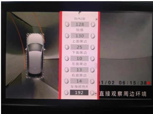
7. 系统设置界面进入到显示设置，该设置可以设定亮度，对比度等显示参数；当画面不满屏时可以调整“上面黑边”“下面黑边”“左面黑边”“右面黑边”四个参数使显示效果达到最佳。
