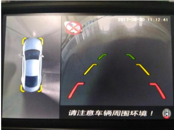
5. 标尺线设置为标尺线，倒车时将显示标尺线。
